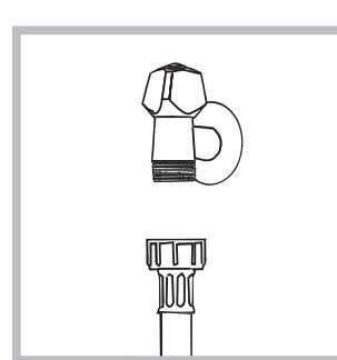
2. Прикрутите шланг подачи к водопроводному крану холодной воды с резьбовым отверстием 3/4 газ., (см. схему).
