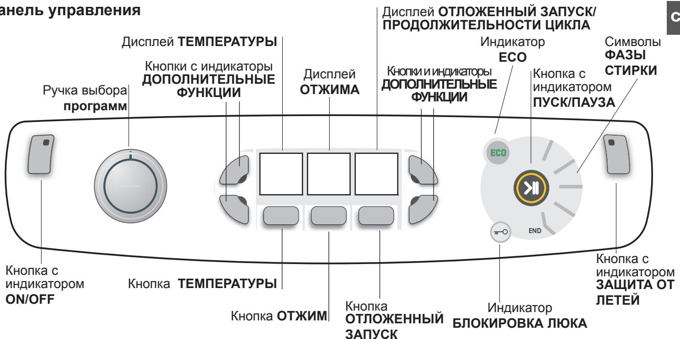
**Кнопка с индикатором ON/OFF:** нажмите кнопку один раз для включения или выключения машины. Зеленый индикатор показывает, что машина включена. Для выключения стиральной машины в процессе стирки необходимо держать нажатой кнопку, примерно 3 секунды. Короткое или случайное нажатие не приведет к отключению машины. В случае выключения машины в процессе стирки текущий цикл отменяется.
